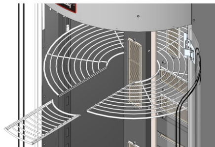
Com o fechamento da grade direcionado para a frente é possível removê-lo sem danificar o equipamento.
